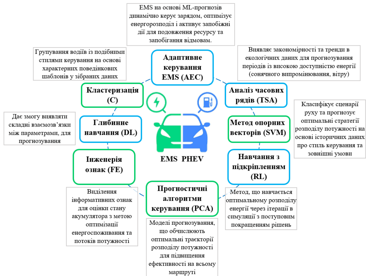
Рис. 2. Основні алгоритми машинного навчання, що застосовуються в EMS для PHEV
