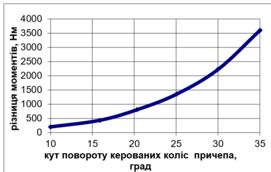
Рис. 2. Залежність різниці моментів на колесах причепа від кута повороту керованих коліс автобуса і причепа
