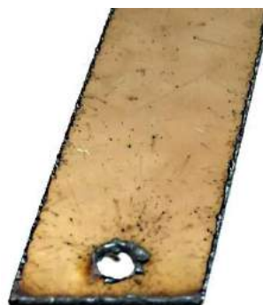
Рис. 6. Дефекты небольших отверстий и прямых углов
