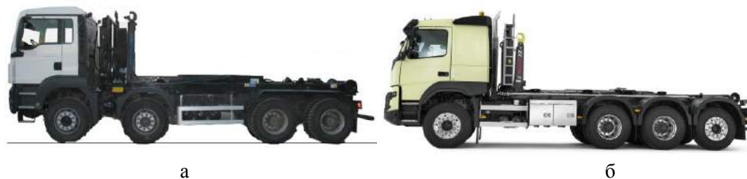
а – два мости передніх та два задніх; б – один міст передній та три задніх Рис. 6. Схеми розміщення мостів чотирьохвісного транспортного засобу
