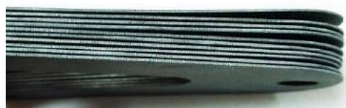
Рис. 8. Торцовая поверхность после галтования
