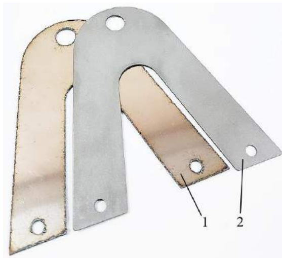
1 – до галтования; 2 – после галтования Рис. 9. Изделие до и после галтования
