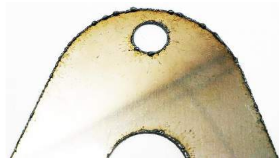
Рис. 5. Оплавления по дуговой траектории реза
