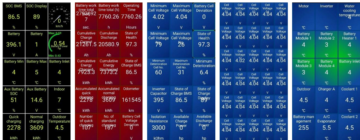
Рис. 3. Екрани меню «Панель приладів» застосунку Car Scanner ELM OBD-II під час діагностики Hyundai Kona Electric
