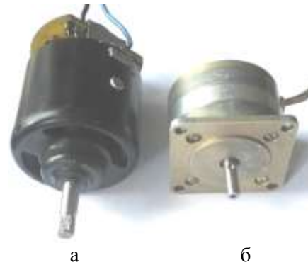
Рис. 2. Досліджувані двигуни: а – двигун постійного струму (мотор опалювача ВАЗ, тип: 45.3730); б – кроковий двигун, тип: ДШ 200-1
