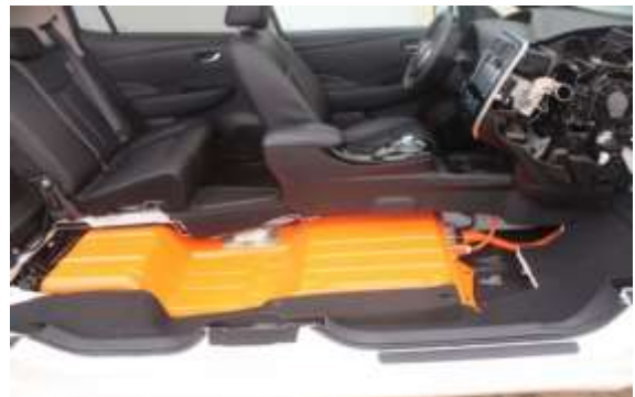
Рис. 4. Разрез нижней части салона, где представлена аккумуляторная батарея Nissan Leaf
