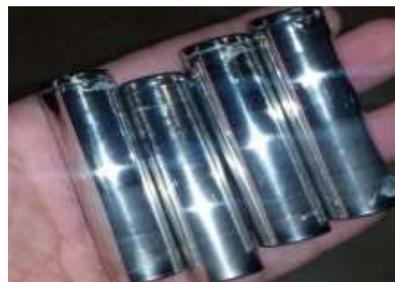
Рис. 8. Литий-ионные ячейки Panasonic аккумуляторной батареи Tesla ModelS
