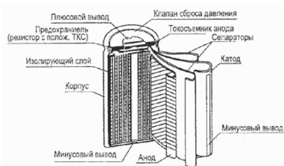
Рис. 1. Устройство литий-ионного (Li-ion) аккумулятора
