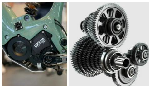
Рис. 1. Електрична допоміжна система Valeo Smart e-bike System [19]
