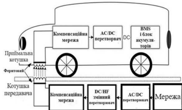
Рис. 2. Принципова блок-схема статичної бездротової зарядної системи для електромобілів [14]
