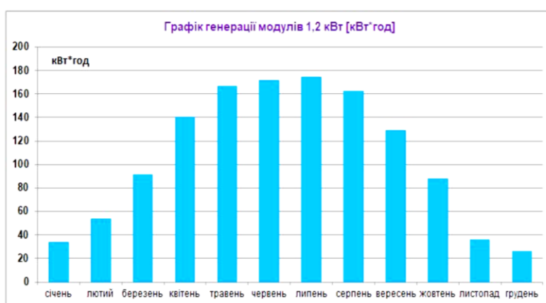
Рис. 6. Генерація електроенергії автономною сонячною електростанцією потужністю 1,2 кВт
