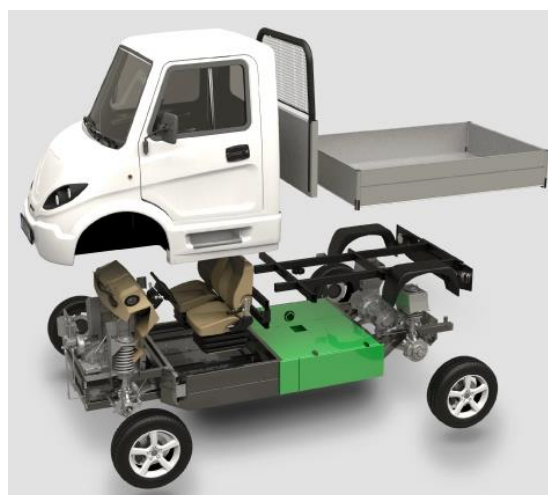
Рис. 8. Електромобіль малої вантажопідйомності моделі "Pro4 Work" з колісною формулою 4x4.1
