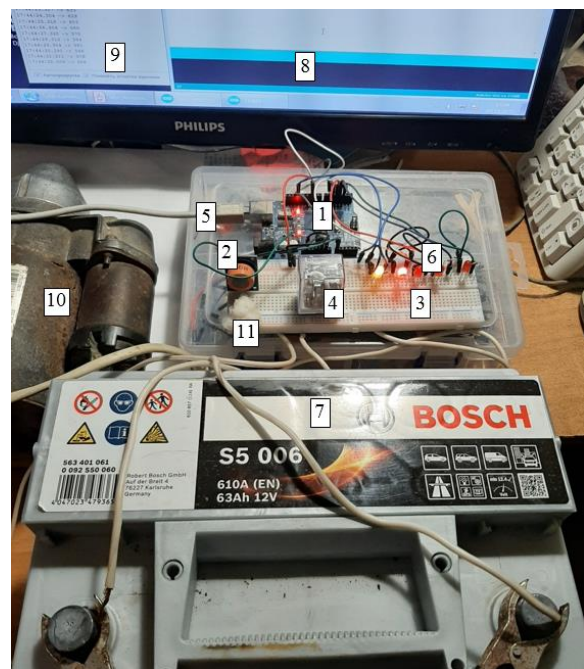
Рис. 8. Експериментальна перевірка блокувального пристрою з автомобільними акумулятором і стартером: 1 – плата Arduino Uno ; 2 – датчик MQ3 ; 3 – макетна плата; 4 – модуль реле; 5 – USB кабель для з'єднання з комп'ютером; 6 – п'ять світлодіодів для індикації величини сигналу MQ3 ; 7 – автомобільний акумулятор; 8 – вікно програми Arduino ; 9 – монітор зі значеннями сигналу; 10 – стартер; 11 – ватка зі спиртом
