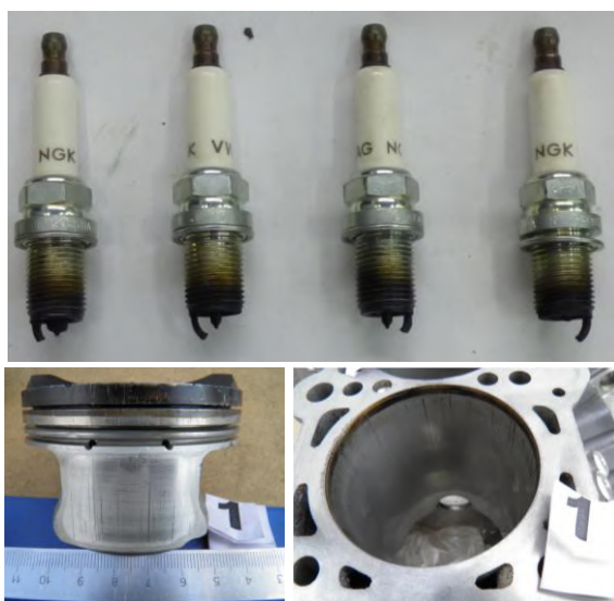
Рис. 9. Поврежденные детали двигателя AUDI-A6
