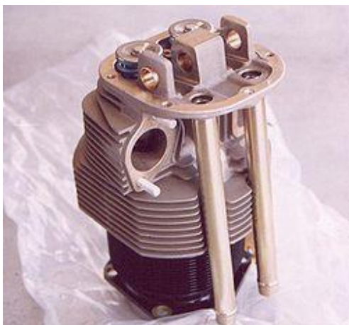
Рис. 3. Система природного повітряного охолодження
