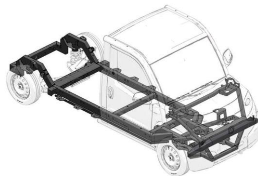
Рис. 5. Конструкція рами електромобіля моделі "Goupil G6"
