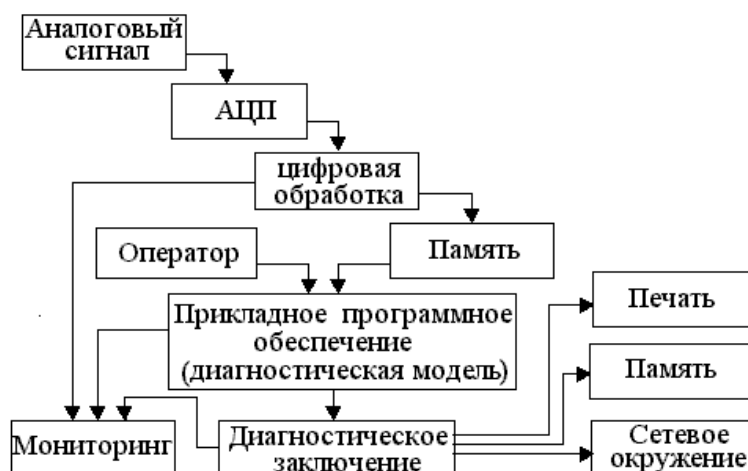
Рис. 1. Схема получения и обработки диагностической информации
