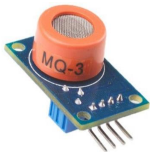
Рис. 4. Датчик парів спирту MQ-3
