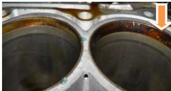
Рис. 19. Расширение пояса нагара в верхней части цилиндра (справа) при работе с деформированным при гидроударе шатуном позволяет однозначно измерить его деформацию
