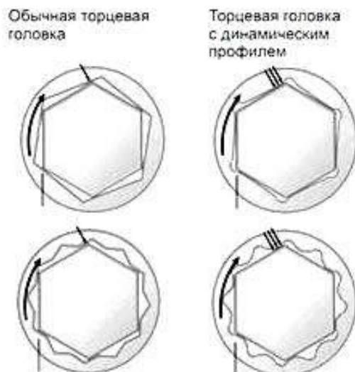
Рис. 3. Форма головки с шестигранным профилем
