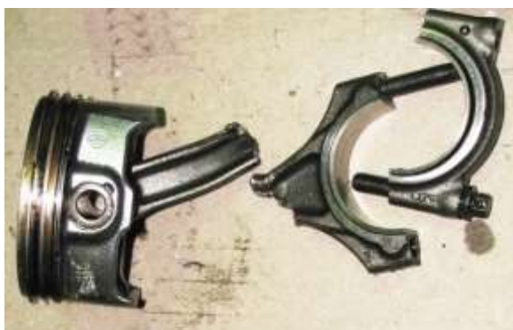
Рис. 18. Усталостное разрушение шатуна после гидроудара не позволяет получить какие-либо данные с помощью прямых измерений
