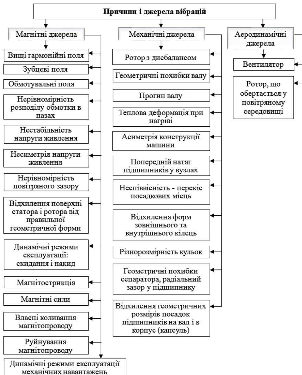
Рис. 3. Причини і джерела вібрації електромагнітного, механічного та аеродинамічного походження асинхронного електродвигуна
