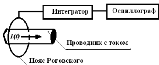
Рис. 3. Схема измерения тока в проводнике с помощью пояса Роговского
