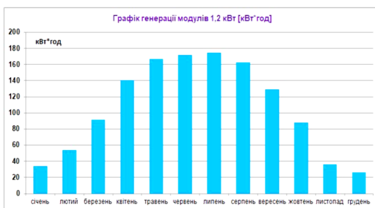
Рис. 6. Генерація електроенергії автономною сонячною електростанцією потужністю 1,2 кВт
