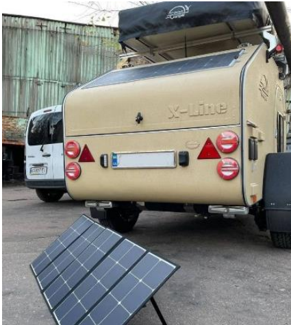
Рис. 1. Причіп-кемпер Lifestylecamper зі стаціонарною сонячною панеллю та портативним модулем
