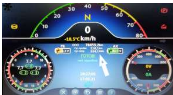
Рис. 2. Монітор з віртуальним лічильником витрати електроенергії за добу
